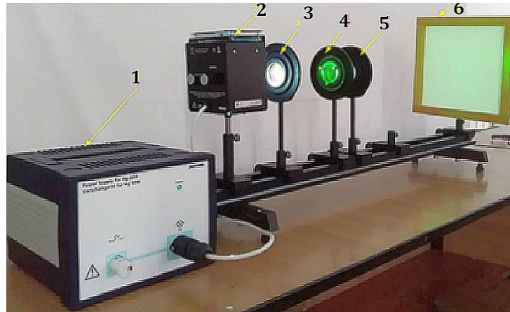
Fig. 4.2.3. Dispozitivul experimental pentru observarea inelelor lui Newton [14]
