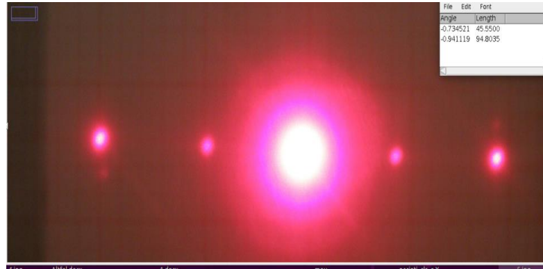
Fig. 4.2.24 Figura de difracție obținută cu rețeaua de difracție în lumină roșie împreună cu valorile poziției y_i pentru maximele de ordinul I și de ordinul II
