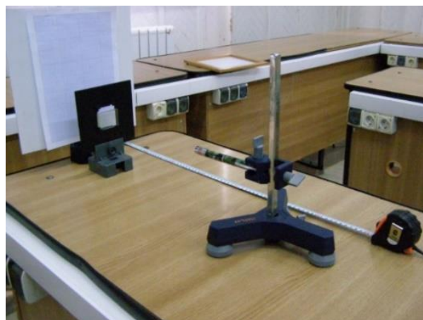
Fig. 4.2.23 Montaj experimental pentru observarea difracției pe o rețea optică
